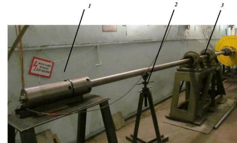
1 - камера сгорания, 2 - опора казенной части установки, 3 - лафет
