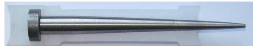
Внешний вид суперкавитирующего кинетического поражающего элемента в ведущем устройстве
